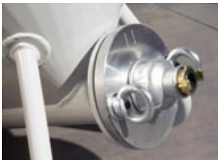
einstellbare Düse (Pos. I – Zement Pos. II – Gips)
